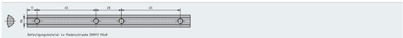
Befestigungsmaterial: 4 x Madenschraube DIN913 M6x8
